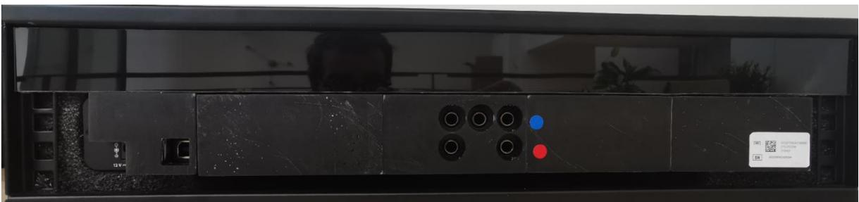
La face arrière comprend essentiellement le panneau de connexion ainsi que les câbles d'alimentation électrique pour l'AudioPod et pour les ports USB de façade.
